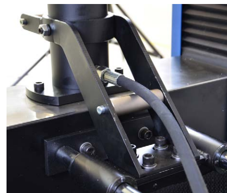
Saída de óleo do Dispositivo para ser acoplado na entrada de óleo da Estrutura de 2000kN.
