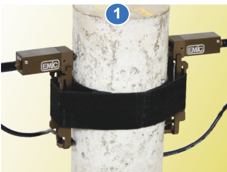
Instrumentação Eletrônica da Série 23 permite uso de 2 canais de deformação simultâneos
