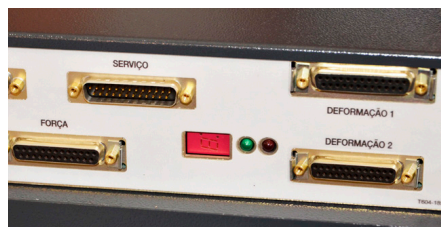
Instrumentação Eletrônica da Série 23 permite uso de 2 canais de deformação simultâneos
