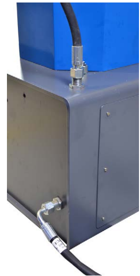
Detalhe da Entrada de Óleo na Estrutura de 2000 kN
